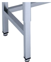
Galda kājas un pastiprinājums tiek izgatavoti no 30x30 mm kvadrātveida caurules. Galda pastiprinājuma augstums no grīdas - 200 mm.
