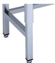
Ноги и усиление изготавливаются из квадратной трубы сечением 25x25мм. Высота усиления стола от пола 200 мм.
